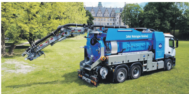
Pojazd do ciśnieniowego czyszczenia kanalizacji.
