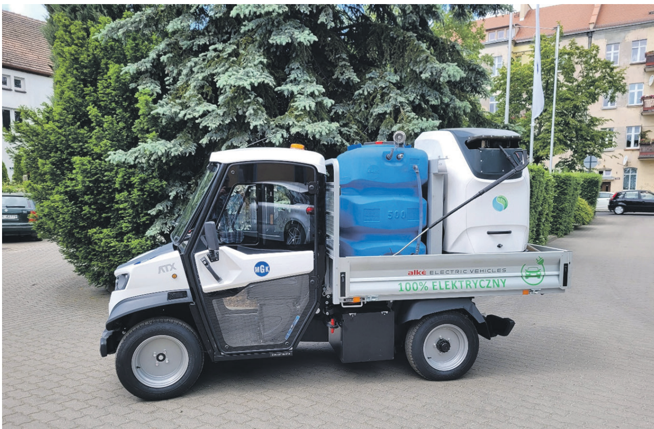
Pojazd elektryczny z odchwaszczarki parową do usuwania zachwaszczenia ulic i placów.
