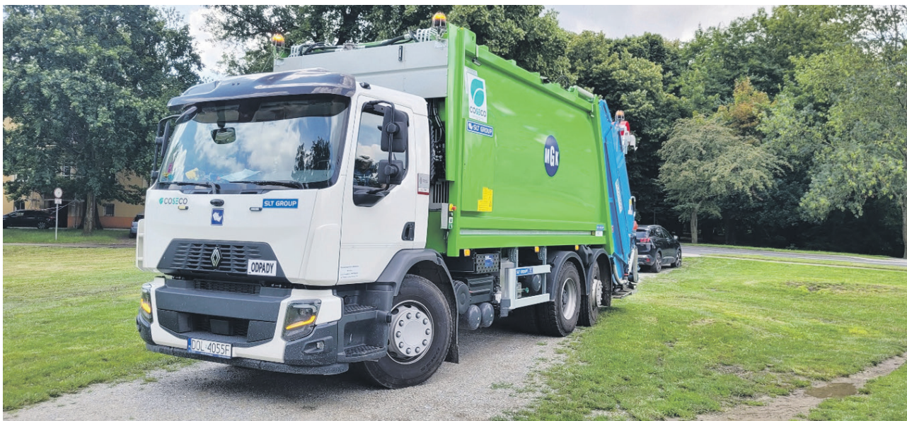
Nowoczesny pojazd do odbioru odpadów na podwoziu RENAULT z zabudową dwukomorową.
